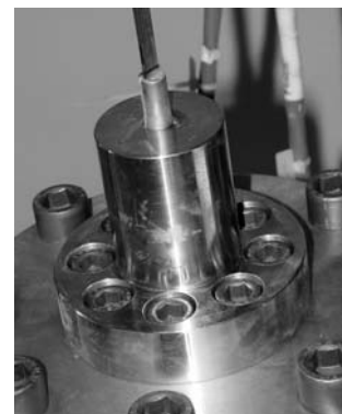
Tests de fatigue sur ancrages jontes carbone (Freyssinet-ENPC)
