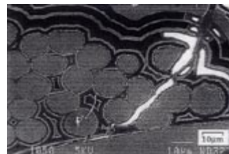
F2 - Composite SiC/SiC à matrice multicouche autocicatrisante. L'oxyde généré à haute température par oxydation de certaines couches emplit les fissures, et protège les fibres d'agressions ultérieures.
