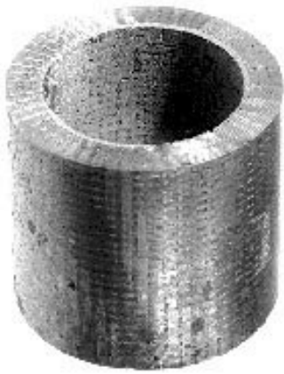
Pièce composite carbone/carbone obtenue par caléfaction
