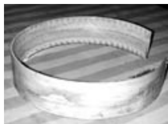
Photo 7 : frette de moteur de traction
