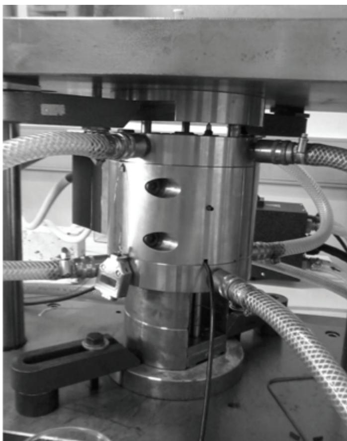
**Moule PvT-xT pour la caractérisation du volume spécifique (jusqu'à 400°C) et des cinétiques de cristallisation des polymères semi-cristallins.**
