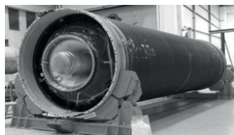
Fig. 9 - Corps de propulseur Carbone/époxy du P120C ©AVIO
