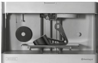
**Figure 2 : photo de l'imprimante de bureau Mark Two de MarkForged [6].**
