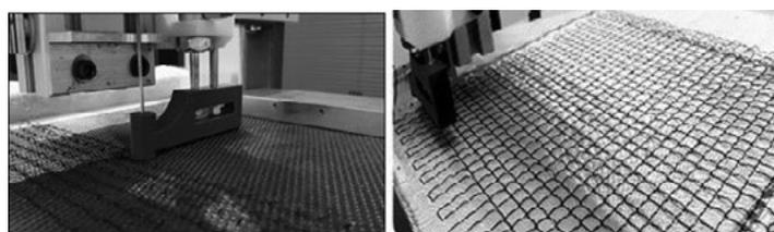
Figure 20 : renforcement dans l'épaisseur par piquage.
