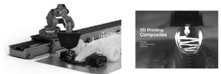
**Figure 6 : image du robot de Continuous Composites et photo de la tête en train d'imprimer [12].**
