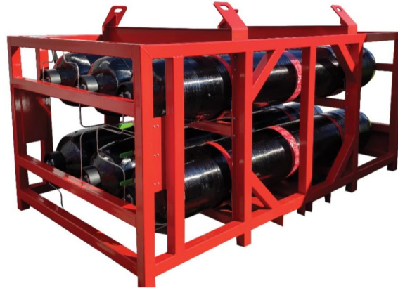
FIGURE 2 : BUNDLE DE RÉSERVOIRS DE TYPE IV POUR LE TRANSPORT D'HYDROGÈNE À 500BAR. CHAQUE RÉSERVOIR A UNE CONTENANCE DE 300LITRE (WWW.MAHYTEC.COM)
