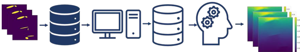
FIGURE 4 : ÉTAPES DE LA MÉTHODE D'APPRENTISSAGE AUTOMATIQUE PROPOSÉE. DE GAUCHE À DROITE : GÉNÉRATION DES DONNÉES BRUTES DE LA MICROSTRUCTURE, SIMULATION DES CHAMPS D'INTÉRÊT, PRÉ-TRAITEMENT DES DONNÉES ET ENTRAÎNEMENT DU MODÈLE D'APPRENTISSAGE AUTOMATIQUE.
