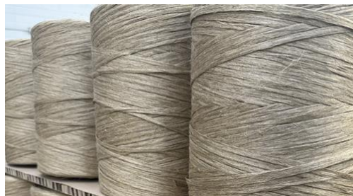
Fig. 1 Roving de fibre de lin [Depestele]
