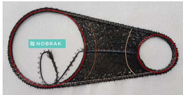
Exemple de préforme réalisée par TFP. Les orientations de fibres sont surlignées en couleur
